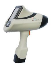
Энергодисперсионный XRF Портативный анализатор металлов и сплавов
